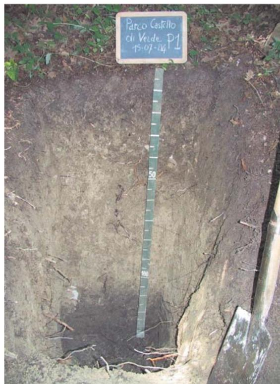
Orizzonte A: 0-15 cm; poco umido; colore tipo ossidato 2,5Y3/2; tessitura franco limosa; scheletro assente; granulometria limosa fine; struttura poliedrica angolare media di grado forte; macropori fini molti; radici molte (40/dm<sup>2</sup>) Ø<1mm (max 2mm), prive di orientamento; calcareo; limite inferiore chiaro, ondulato.
